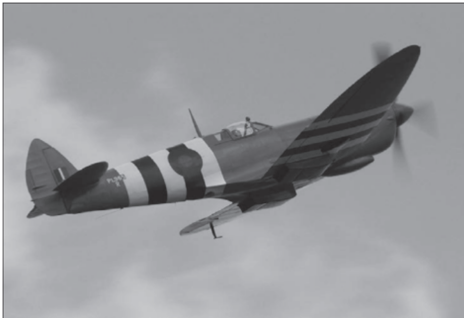
Supermarine PR Spitfire Mark XI. In de onderzijde van de voorste witte band om de romp is één van de openingen voor de verticale camera's zichtbaar.
